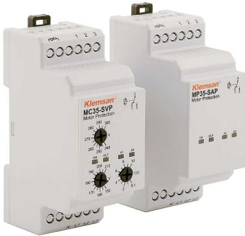
Relé de asimetría y Secuencia de fase. Esta unidad electrónica tiene por finalidad monitorear constantemente la red local. Es la encargada de poner en servicio al grupo electrógeno ante un eventual corte de energía. Sus parámetros de regulación son porcentaje de caída de tensión y ajuste tiempo de recuperación.
