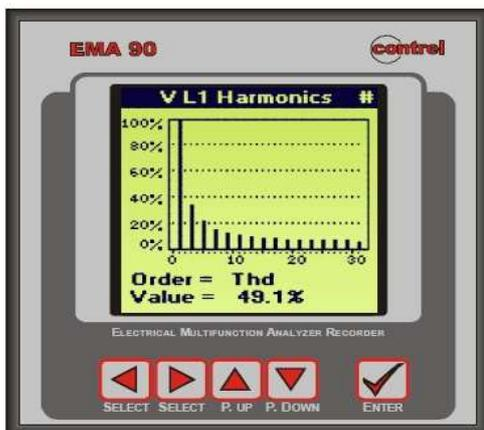
Consiste en un analizador Industrial, que permite visualizar y supervisar todas las variables eléctricas presentes en la planta, tomando muestras en el tiempo, las variables del equipo son enviadas por interfaz RS 485, protocolo Modbus - RTU
