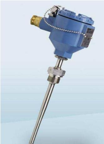
Censor de temperatura. Consiste en un alambre de platino que a 0 grados C tiene 100 ohms y que al aumentar la temperatura aumenta la potencia eléctrica. El incremento de la fuerza no es lineal, pero si creciente y característicos del platino, de tal forma que mediante tabla es posible encontrar la temperatura exacta a que corresponde
