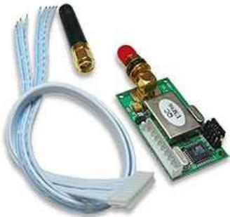
Este pequeño radio modem utiliza una interfaz serial. Lo que sea que entre por el pin TX a 9600bps es recibido en el pin RX de la otra unidad. Todo el bufferig y la detección de errores es manejada internamente. Esta unidad puede ser conectada a niveles TTL (para microcontroladores) o directamente a una interfaz RS232/RS485.
